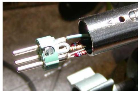
Otra aplicación que puede resultar útil es la de sumador. Mi reproductor de DVD tiene una salida estéreo con conectores RCA, el televisor tiene entrada de audio mono (RCA), para oír los dos canales del estéreo debo juntarlos, pero si los uno directamente, el nivel de la señal
